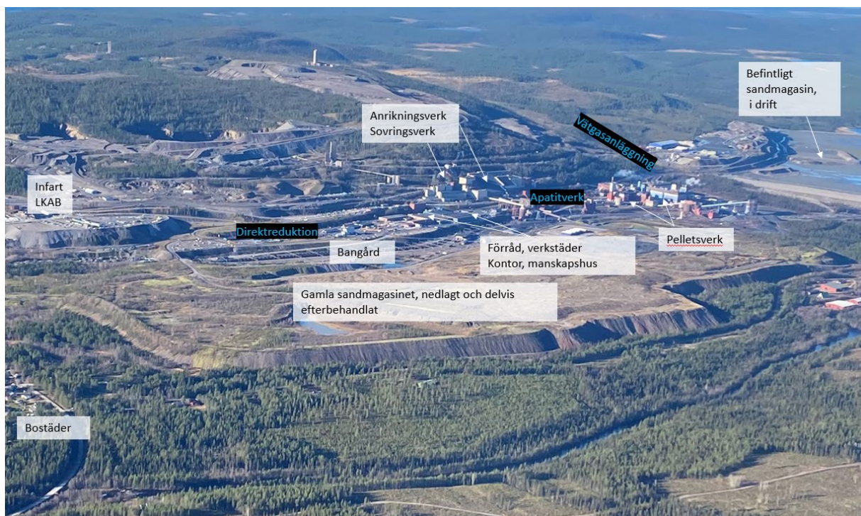
Figur 19 Drönanalyse över Vitåfors gruvområde sett från öst med beskrivning av befintliga anläggningar och funktioner. Område för apatitverk, direktreduktion och vätgasanläggning har schematisk markerats för orientering.
