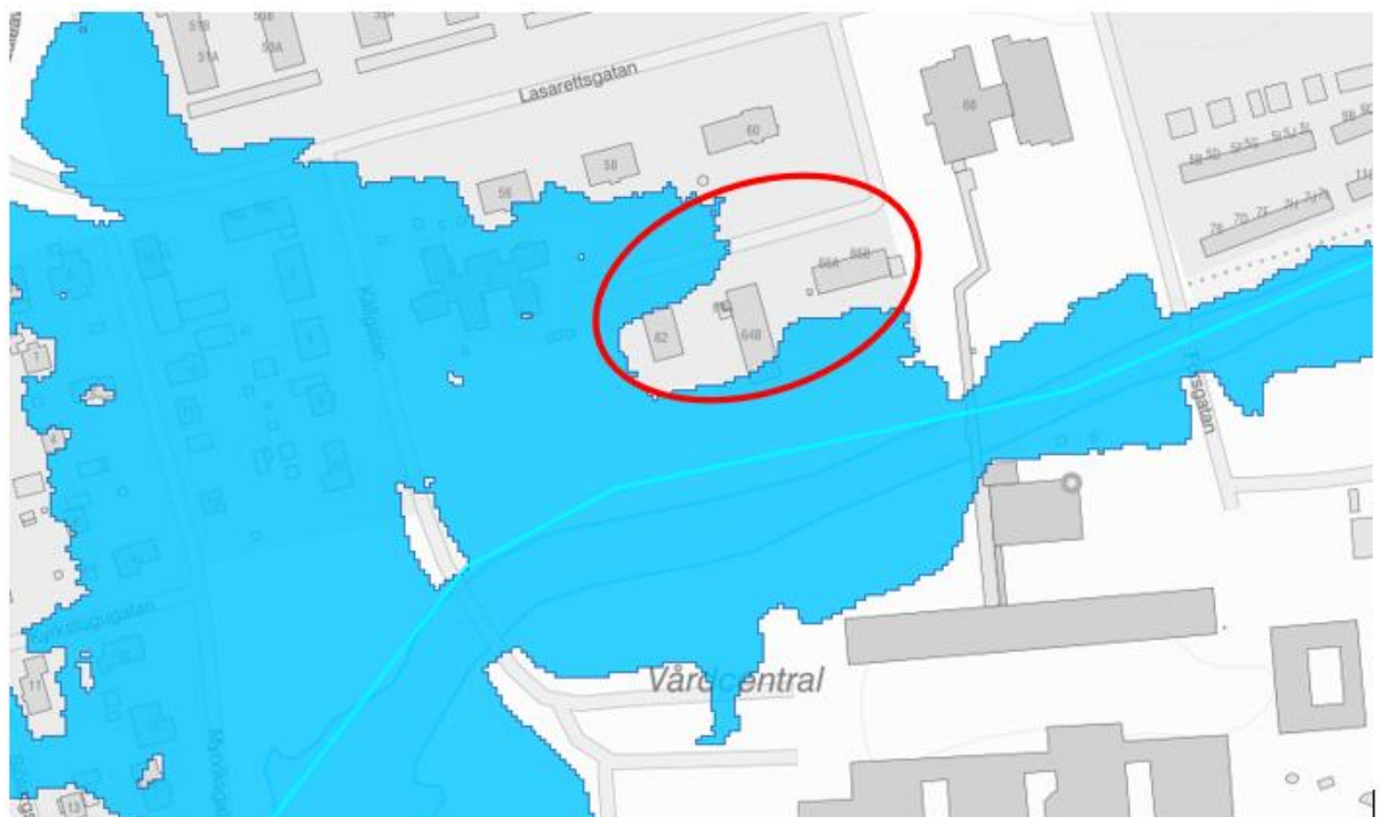
Figur 7: Utklipp ur MSB's översvämningsskartering, 100 årsflöde, klimatanpassad. Planområdet är markerad med en röd cirkel.
