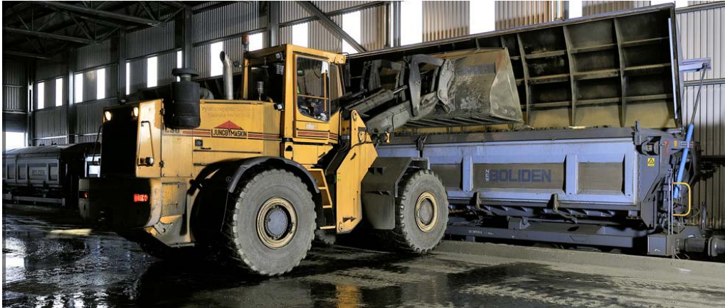
Figur 14. Lastning av järnvägsvagnar i terminalens sliglager. Foto Daniel Olausson/Boliden
