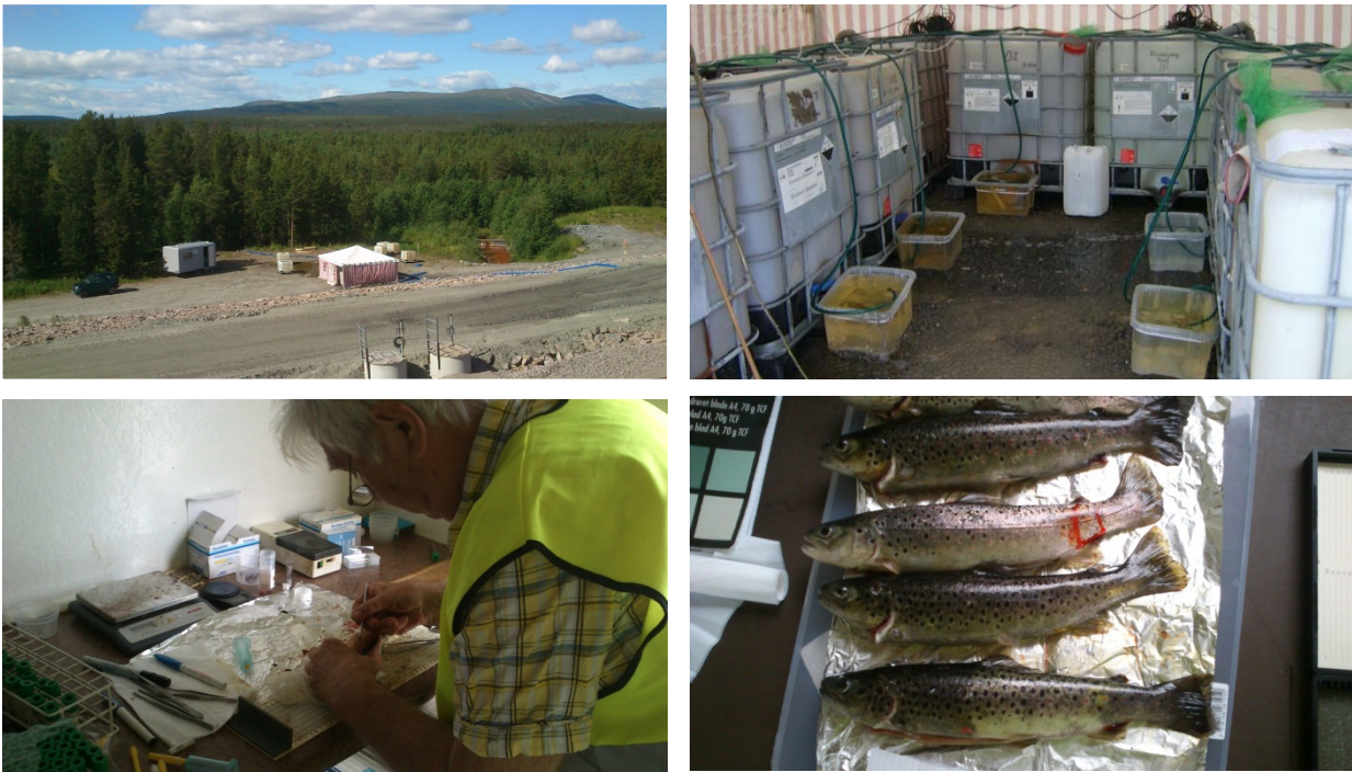
Figur 47. Anläggningen för fiskförsök sommaren 2012 nedanför klarningsmagasinet. Försökupställning med tankar med olika spädningar av magasinsvatten och bäckvatten. Provtagning av 3-årig öring som exponerats under en månad. Foto: Olof Sangfors.
