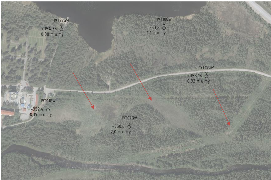
Figur 8. Installerade grundvattenrör, pilar indikerar grundvattnets strömningsriktning.
