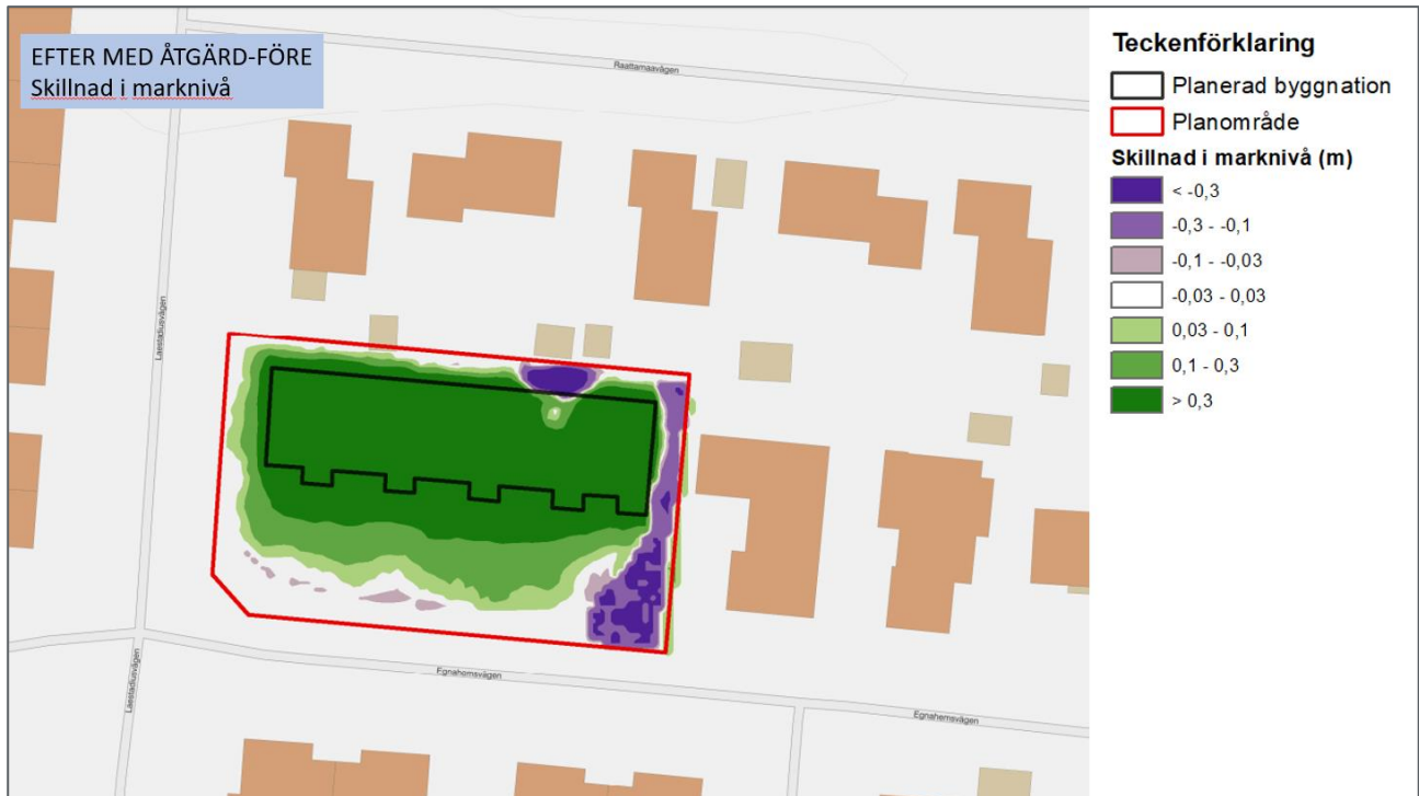
Figur 20. Förändring av marknivåer för framtida situation med åtgärdsförslag jämfört med befintlig situation. Gröna områden indikerar en höjning av marknivån jämfört med befintlig och lila områden indikerar en sänkning av marknivå jämfört med befintligt.
