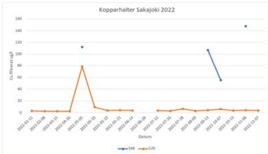
Figur 8.6. Uppmätta filtrerade kopparhalter i sedimentationsbassäng Sakajärvi (598) och Sakajoki.
